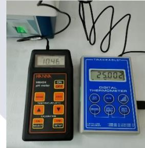
Realizamos una comparación de los valores obtenidos por un instrumento de medición con medidas correspondientes con herramientas modernas y especializadas para laboratorios de calibración.
